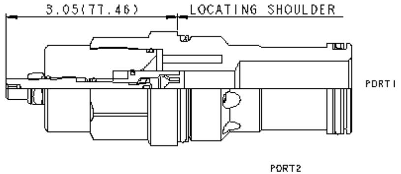
Les étrangleurs à pointeau bidirectionnels sont des orifices réglables utilisés pour réguler le débit. Ils permettent une infinité de réglages depuis la fermeture complètement étanche jusqu'au diamètre maximum de l'orifice. Ils ne sont pas compensés en pression. Ils peuvent être utilisés pour contrôler un débit ou comme un simple robinet ouvert ou fermé.
