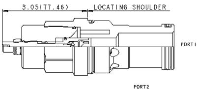
Die voll verstellbare Blende ermöglicht das feinfühlige Dosieren von Volumenströmen. Der Einstellbereich reicht von vollständig geschlossen stufenlos bis zum maximalen Blendendurchmesser. Der Volumenstrom ist abhängig vom Druckabfall. Das Ventil kann als Strom- und/oder Sperrventil eingesetzt werden.
