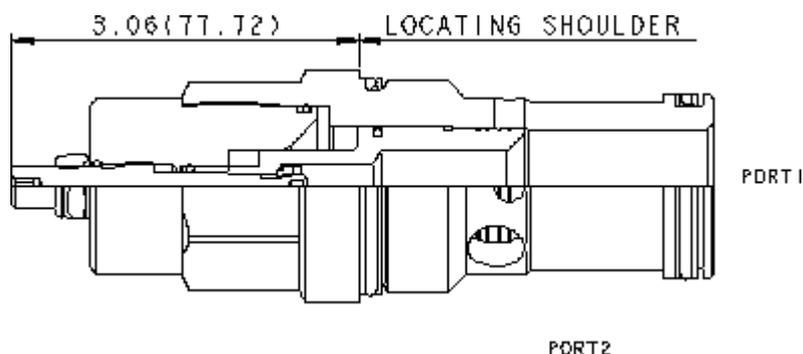
Les étrangleurs à pointeau bidirectionnels sont des orifices réglables utilisés pour réguler le débit. Ils permettent une infinité de réglages depuis la fermeture complètement étanche jusqu'au diamètre maximum de l'orifice. Ils ne sont pas compensés en pression. Ils peuvent être utilisés pour contrôler un débit ou comme un simple robinet ouvert ou fermé.
