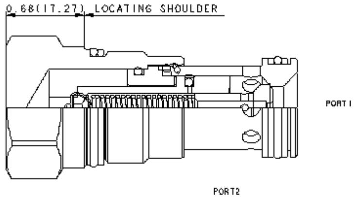
Das Pumpenanlaufventil senkt den Leistungsbedarf beim Anlaufen einer Pumpe, entlüftet gleichzeitig die Versorgungsleitung und verbessert dadurch das Ansaugverhalten der Pumpe, besonders bei Wegeventil-Schaltungen mit geschlossener Mittelstellung.
