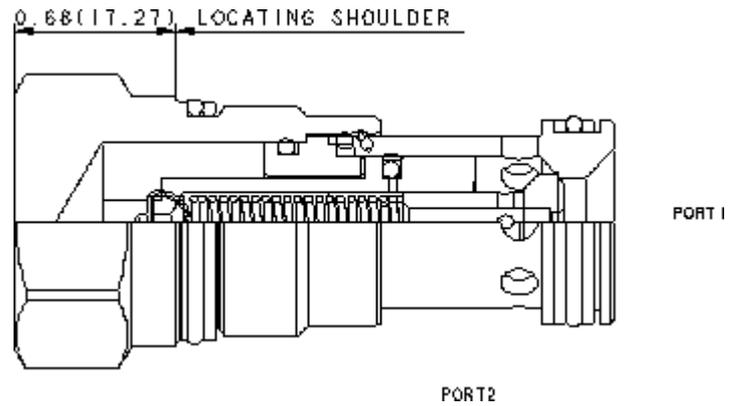
Les cartouches de démarrage et purge d'air servent à purger l'air emprisonné dans les circuits, à réduire l'appel de puissance et faciliter l'amorçage de la pompe lors du démarrage de circuits en charge.
