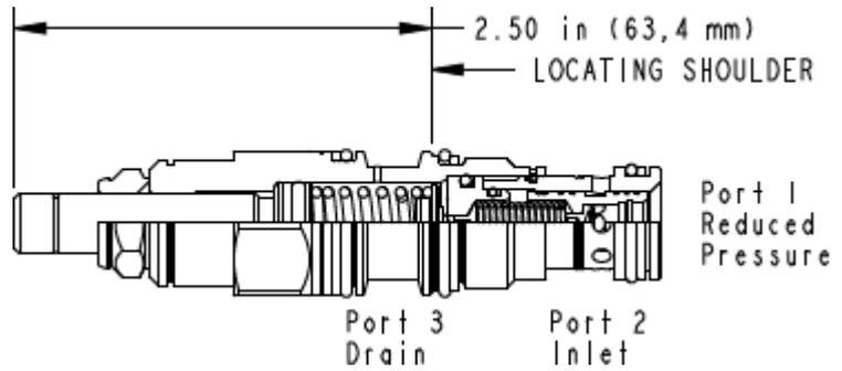
Vorgesteuerte 2-Wege-Druckregler reduzieren einen hohen Primärdruck an Anschluss 2 auf einen niedrigeren, geregelten Druck an Anschluss 1. Dadurch können Schaltungen mit unterschiedlichen Drücken von einer Pumpe versorgt werden.
