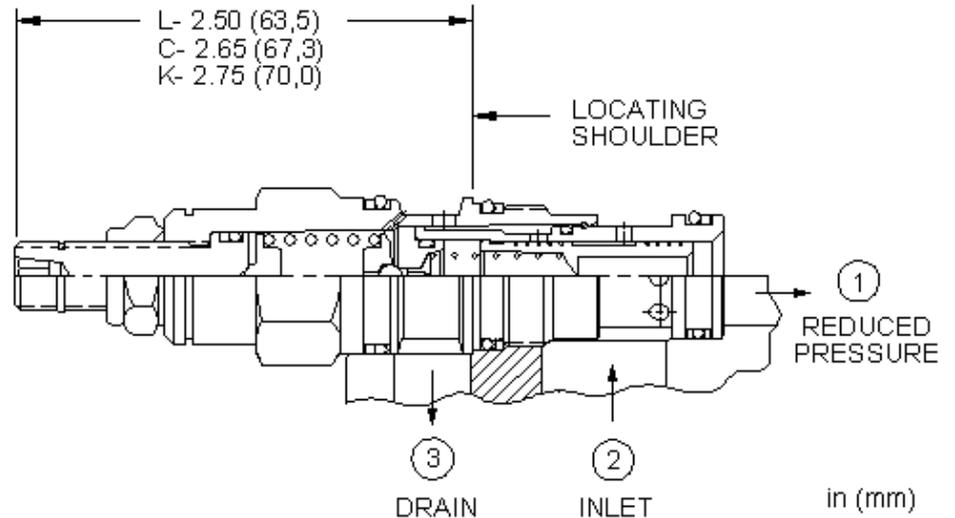
Les réducteurs de pression pilotés réduisent la pression primaire élevée de l'entrée (chambre 2) en une pression réduite constante dans la chambre 1, permettant aux circuits nécessitant de multiples pressions d'être opérationnels à partir d'une seule pompe.
