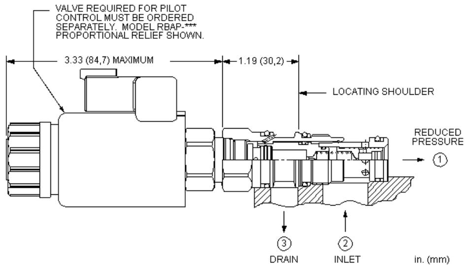
Dieses Druckregelement ist in der Ruhestellung geöffnet und mit einer Einschraubbohrung für ein Vorsteuerventil ausgestattet. In die Einschraubbohrung kann jedes in die T-8A passende Druckventil eingesetzt werden. Das Ventil reduziert einen hohen Primärdruck an Anschluss 2 auf einen niedrigeren, geregelten Druck an Anschluss 1. Der Einstellwert des Vorsteuerventils bestimmt die Druckdifferenz zwischen Anschluss 1 und dem Entlastungsdruck an Anschluss 3.
