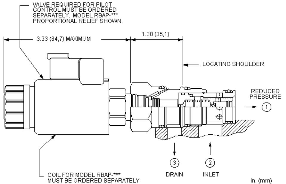
Dieses Druckregелеlement ist in der Ruhestellung geöffnet und mit einer Einschraubbohrung für ein Vorsteuerventil ausgestattet. In die Einschraubbohrung kann jedes in die T-8A passende Druckventil eingesetzt werden. Das Ventil reduziert einen hohen Primärdruck an Anschluss 2 auf einen niedrigeren, geregelten Druck an Anschluss 1. Der Einstellwert des Vorsteuerventils bestimmt die Druckdifferenz zwischen Anschluss 1 und dem Entlastungsdruck an Anschluss 3.
