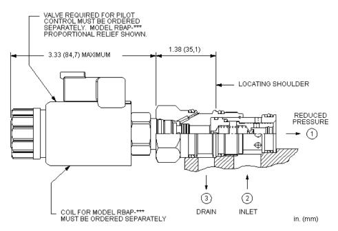
Dieses Druckregelelement ist in der Ruhestellung geöffnet und mit einer Einschraubbohrung für ein Vorsteuerventil ausgestattet. In die Einschraubbohrung kann jedes in die T-8A passende Druckventil eingesetzt werden. Das Ventil reduziert einen hohen Primärdruck an Anschluss 2 auf einen niedrigeren, geregelten Druck an Anschluss 1. Der Einstellwert des Vorsteuerventils bestimmt die Druckdifferenz zwischen Anschluss 1 und dem Entlastungsdruck an Anschluss 3.
