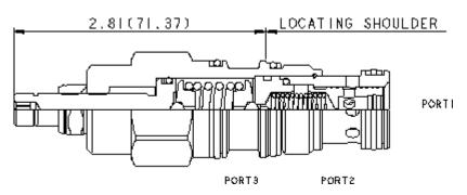
Les réducteurs de pression pilotés réduisent la pression primaire élevée de l'entrée (chambre 2) en une pression réduite constante dans la chambre 1, permettant aux circuits nécessitant de multiples pressions d'être opérationnels à partir d'une seule pompe.
