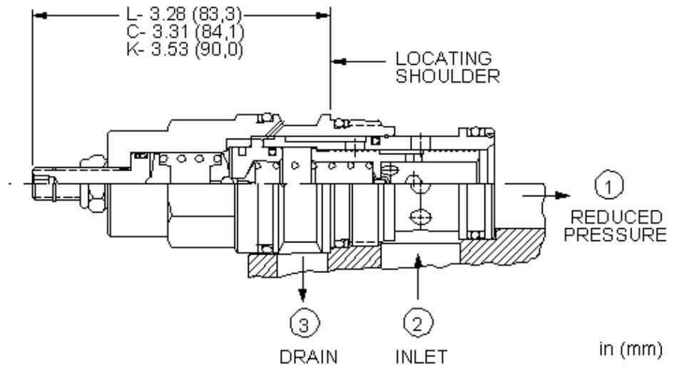
Vorgesteuerte 2-Wege-Druckregler reduzieren einen hohen Primärdruck an Anschluss 2 auf einen niedrigeren, geregelten Druck an Anschluss 1. Dadurch können Schaltungen mit unterschiedlichen Drücken von einer Pumpe versorgt werden.
