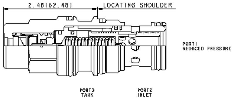
Pneumatisch betätigte, vorgesteuerte 2-Wege-Druckregelventile arbeiten mit Druckluft und einer Membran statt einer verstellbaren Feder und reduzieren einen hohen Primärdruck an Anschluss 2 auf einen niedrigeren, geregelten Druck an Anschluss 1. Die pneumatische Ansteuerung erfolgt über einen externen Anschluss im Ventilschsechskant. So kann der Öldruck ferngesteuert und explosions sicher eingestellt werden. Der hydraulische Druck ist zu dem Luftdruck direkt proportional (20:1).
