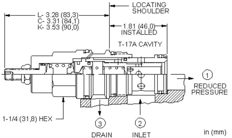
Vorgesteuerte 2-Wege-Druckregler reduzieren einen hohen Primärdruck an Anschluss 2 auf einen niedrigeren, geregelten Druck an Anschluss 1. Dadurch können Schaltungen mit unterschiedlichen Drücken von einer Pumpe versorgt werden.
