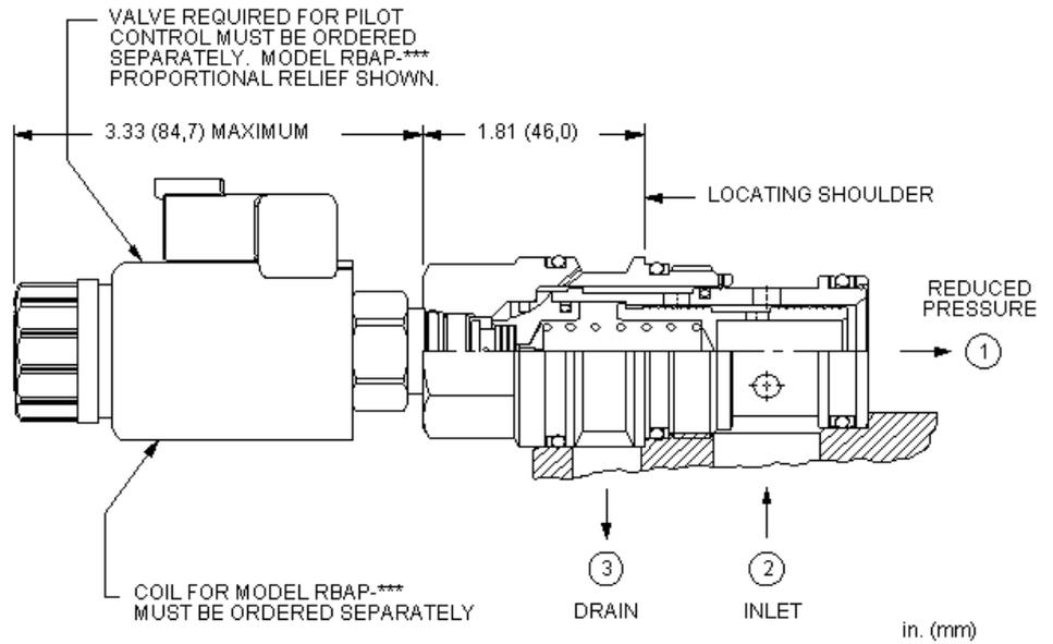
Dieses Druckregelelement ist in der Ruhestellung geöffnet und mit einer Einschraubbohrung für ein Vorsteuerventil ausgestattet. In die Einschraubbohrung kann jedes in die T-8A passende Druckventil eingesetzt werden. Das Ventil reduziert einen hohen Primärdruck an Anschluss 2 auf einen niedrigeren, geregelten Druck an Anschluss 1. Der Einstellwert des Vorsteuerventils bestimmt die Druckdifferenz zwischen Anschluss 1 und dem Entlastungsdruck an Anschluss 3.
