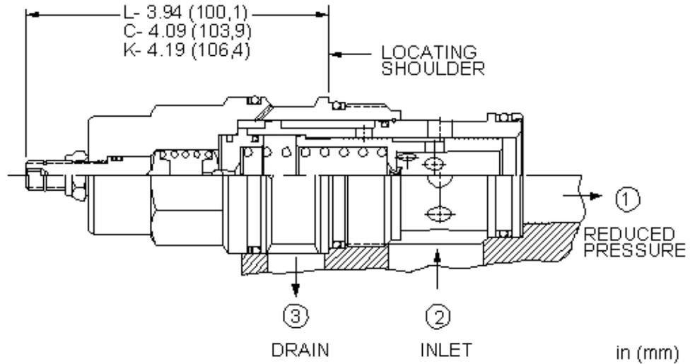
Vorgesteuerte 2-Wege-Druckregler reduzieren einen hohen Primärdruck an Anschluss 2 auf einen niedrigeren, geregelten Druck an Anschluss 1. Dadurch können Schaltungen mit unterschiedlichen Drücken von einer Pumpe versorgt werden.
