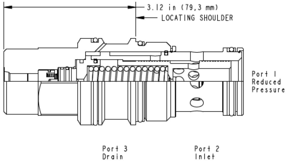
Les réducteurs de pression pilotés à partir d'une pression pneumatique utilisent de l'air comprimé derrière un diaphragme pour remplacer le ressort de tarage réglable. Ils réduisent la pression primaire élevée de l'entrée (chambre 2) en une pression réduite constante dans la chambre 1. Le signal pneumatique est à connecter à l'orifice situé dans la partie hexagonale de la cartouche, et le tarage hydraulique est directement proportionnel à la pression d'air dans la proportion de 20/1 (huile/air).
