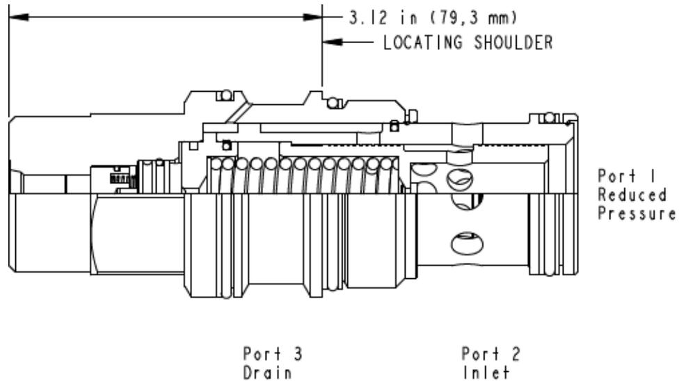
Pneumatisch betätigte, vorgesteuerte 2-Wege-Druckregelventile arbeiten mit Druckluft und einer Membran statt einer verstellbaren Feder und reduzieren einen hohen Primärdruck an Anschluss 2 auf einen niedrigeren, geregelten Druck an Anschluss 1. Die pneumatische Ansteuerung erfolgt über einen externen Anschluss im Ventilschsechskant. So kann der Öldruck ferngesteuert und explosions sicher eingestellt werden. Der hydraulische Druck ist zu dem Luftdruck direkt proportional (20:1).
