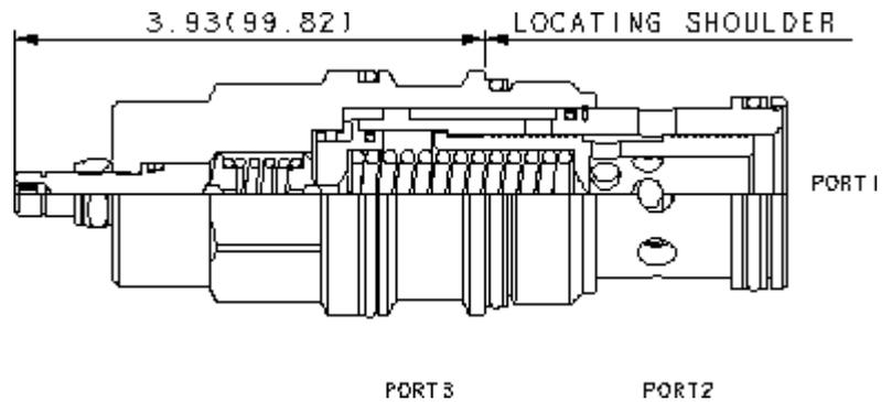
Les réducteurs de pression pilotés réduisent la pression primaire élevée de l'entrée (chambre 2) en une pression réduite constante dans la chambre 1, permettant aux circuits nécessitant de multiples pressions d'être opérationnels à partir d'une seule pompe.
