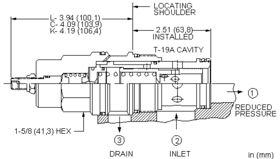
Vorgesteuerte 2-Wege-Druckregler reduzieren einen hohen Primärdruck an Anschluss 2 auf einen niedrigeren, geregelten Druck an Anschluss 1. Dadurch können Schaltungen mit unterschiedlichen Drücken von einer Pumpe versorgt werden.
