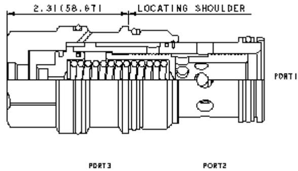
Dieses Druckregелеlement ist in der Ruhestellung geöffnet und mit einer Einschraubbohrung für ein Vorsteuerventil ausgestattet. In die Einschraubbohrung kann jedes in die T-8A passende Druckventil eingesetzt werden. Das Ventil reduziert einen hohen Primärdruck an Anschluss 2 auf einen niedrigeren, geregelten Druck an Anschluss 1. Der Einstellwert des Vorsteuerventils bestimmt die Druckdifferenz zwischen Anschluss 1 und dem Entlastungsdruck an Anschluss 3.
