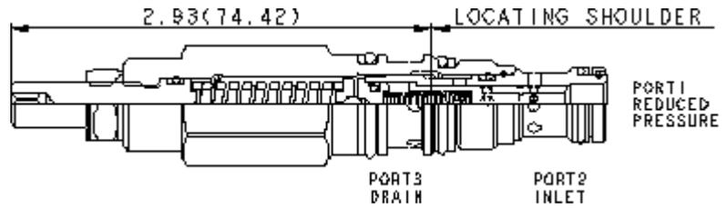
Les réducteurs de pression pilotés à 3 voies réduisent la pression primaire élevée de l'entrée (chambre 2) en une pression réduite constante dans la chambre 1 et fonctionnent en limiteur de pression capable du plein débit de la chambre 1 vers le réservoir (chambre 3).
