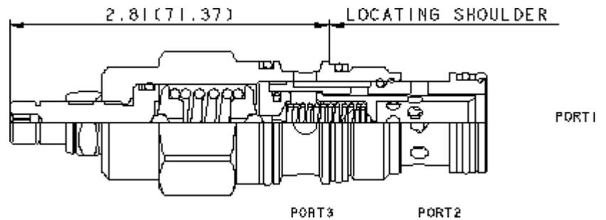
Dieses vorgesteuerte 3-Wege-Druckregelventil reduziert einen hohen Primärdruck an Anschluss 2 auf einen niedrigeren, geregelten Druck an Anschluss 1. Überdruck an Anschluss 1 wird über Anschluss 3 zum Tank hin abgebaut.
