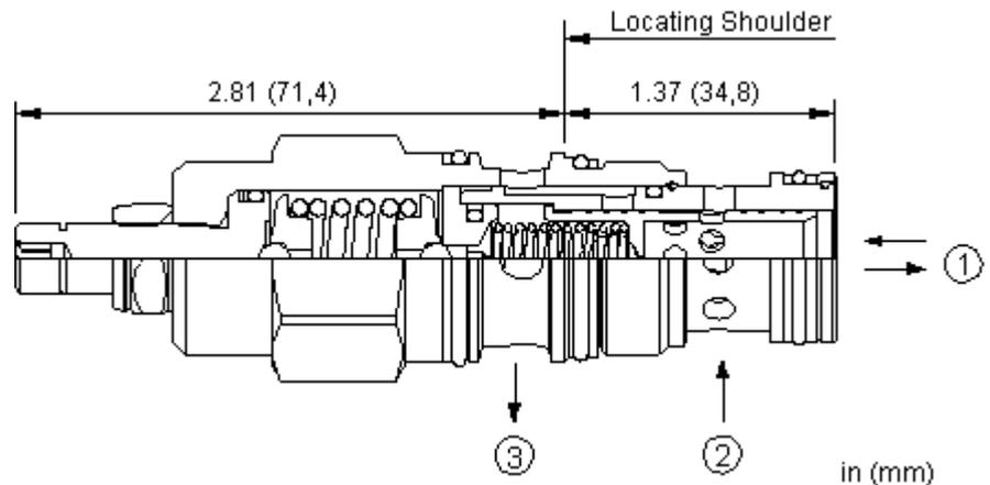
Les réducteurs de pression pilotés à 3 voies réduisent la pression primaire élevée de l'entrée (chambre 2) en une pression réduite constante dans la chambre 1 et fonctionnent en limiteur de pression capable du plein débit de la chambre 1 vers le réservoir (chambre 3).
