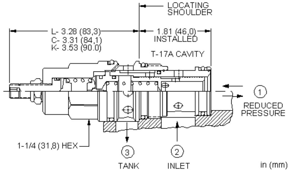
Les réducteurs de pression pilotés à 3 voies réduisent la pression primaire élevée de l'entrée (chambre 2) en une pression réduite constante dans la chambre 1 et fonctionnent en limiteur de pression capable du plein débit de la chambre 1 vers le réservoir (chambre 3).
