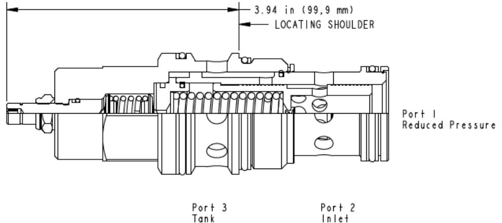
Les réducteurs de pression pilotés à 3 voies réduisent la pression primaire élevée de l'entrée (chambre 2) en une pression réduite constante dans la chambre 1 et fonctionnent en limiteur de pression capable du plein débit de la chambre 1 vers le réservoir (chambre 3).
