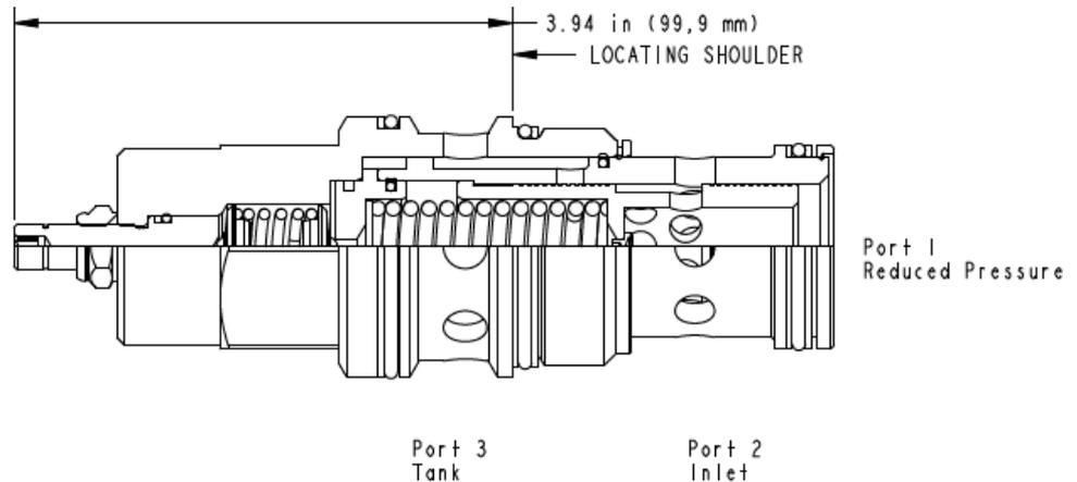
Dieses vorgesteuerte 3-Wege-Druckregelventil reduziert einen hohen Primärdruck an Anschluss 2 auf einen niedrigeren, geregelten Druck an Anschluss 1. Überdruck an Anschluss 1 wird über Anschluss 3 zum Tank hin abgebaut.
