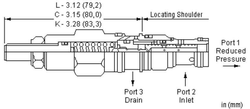
Direkt gesteuerte 3-Wege-Druckregelventile reduzieren einen hohen Primärdruck an Anschluss 2 auf einen niedrigeren, geregelten Druck an Anschluss 1. Die Druckbegrenzungsfunktion bewirkt, dass bei Überdruck an Anschluss 1 Öl über Anschluss 3 zum Tank abfließt. Die konstruktive Bedämpfung dieses Ventils führt zu stabiler Funktion auch bei hohen Differenzdrücken.
