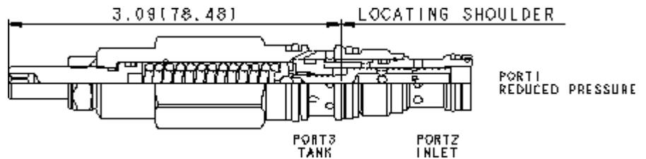
Direkt gesteuerte 3-Wege-Druckregelventile reduzieren einen hohen Primärdruck am Einlass (Anschluss 2) auf einen niedrigeren, geregelten Druck am Anschluss 1. Die konstruktive Bedämpfung dieses Ventils führt zu stabiler Funktion auch bei hohen, geregelten Drücken. Dieses Ventil ist offen in der Übergangsstellung zwischen Druckminderung und Druckbegrenzung. Es erlaubt eine gute Druckkontrolle und eine hohe Dynamik.
