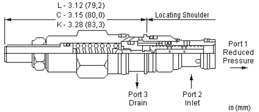
Direkt gesteuerte 3-Wege-Druckregelventile reduzieren einen hohen Primärdruck am Einlass (Anschluss 2) auf einen niedrigeren, geregelten Druck am Anschluss 1. Die konstruktive Bedämpfung dieses Ventils führt zu stabiler Funktion auch bei hohen, geregelten Drücken. Dieses Ventil ist offen in der Übergangsstellung zwischen Druckminderung und Druckbegrenzung. Es erlaubt eine gute Druckkontrolle und eine hohe Dynamik.
