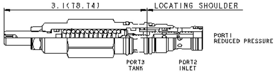
Direkt gesteuerte 2-Wege-Druckregelventile reduzieren einen hohen Primärdruck an Anschluss 2 auf einen niedrigeren, geregelten Druck an Anschluss 1. Die konstruktive Bedämpfung dieses Ventils führt zu stabiler Funktion auch bei hohen Differenzdrücken.
