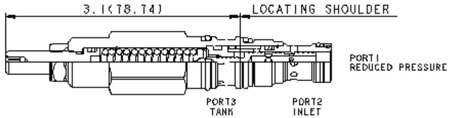
Les réducteurs de pression à action directe à 2 voies réduisent la pression primaire élevée de l'entrée (chambre 2) en une pression réduite constante dans la chambre 1. Ces valves sont amorties pour un fonctionnement stable autorisant un différentiel de pression élevé.
