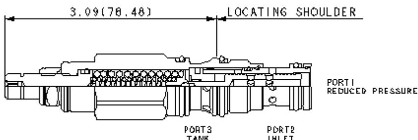
Les réducteurs de pression à action directe à 3 voies réduisent la pression primaire élevée de l'entrée (chambre 2) en une pression réduite constante dans la chambre 1 et fonctionnent en limiteur de pression capable du plein débit de la chambre 1 vers le réservoir (chambre 3). Ces valves sont amorties pour un fonctionnement stable autorisant un différentiel de pression élevé.
