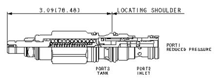
Direkt gesteuerte 3-Wege-Druckregelventile reduzieren einen hohen Primärdruck am Einlass (Anschluss 2) auf einen niedrigeren, geregelten Druck am Anschluss 1. Die konstruktive Bedämpfung dieses Ventils führt zu stabiler Funktion auch bei hohen, geregelten Drücken. Dieses Ventil ist offen in der Übergangsstellung zwischen Druckminderung und Druckbegrenzung. Es erlaubt eine gute Druckkontrolle und eine hohe Dynamik.
