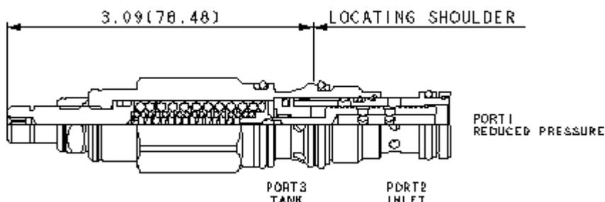
Les réducteurs de pression à action directe à 2 voies réduisent la pression primaire élevée de l'entrée (chambre 2) en une pression réduite constante dans la chambre 1. Ces valves sont amorties pour un fonctionnement stable autorisant un différentiel de pression élevé. Cette valve est ouverte pendant la transition de la fonction réduction à la fonction limitation permettant un bon contrôle de la pression et une réponse dynamique
