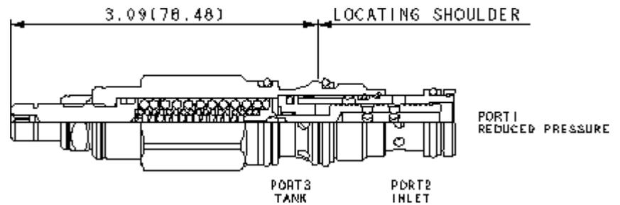
Direkt gesteuerte 3-Wege-Druckregelventile reduzieren einen hohen Primärdruck am Einlass (Anschluss 2) auf einen niedrigeren, geregelten Druck am Anschluss 1. Die konstruktive Bedämpfung dieses Ventils führt zu stabiler Funktion auch bei hohen, geregelten Drücken. Dieses Ventil ist offen in der Übergangsstellung zwischen Druckminderung und Druckbegrenzung. Es erlaubt eine gute Druckkontrolle und eine hohe Dynamik.
