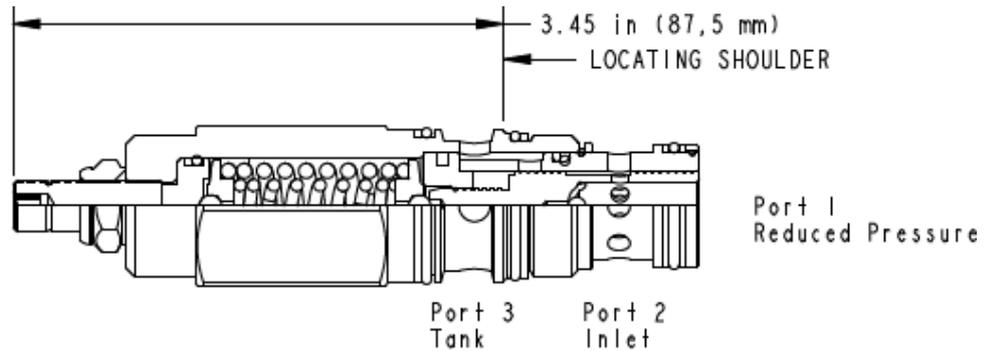
Les réducteurs de pression à action directe à 3 voies réduisent la pression primaire élevée de l'entrée (chambre 2) en une pression réduite constante dans la chambre 1 et fonctionnent en limiteur de pression capable du plein débit de la chambre 1 vers le réservoir (chambre 3). Ces valves sont amorties pour un fonctionnement stable autorisant un différentiel de pression élevé.
