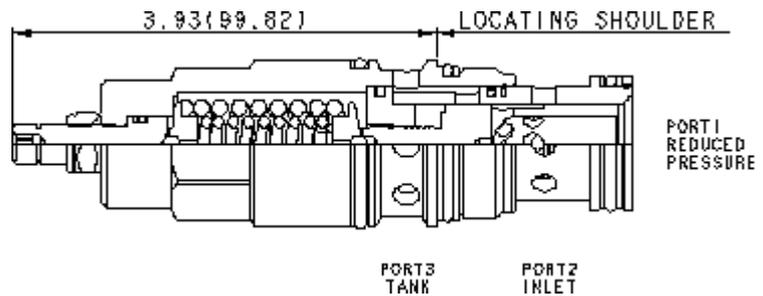
Les réducteurs de pression à action directe à 3 voies réduisent la pression primaire élevée de l'entrée (chambre 2) en une pression réduite constante dans la chambre 1 et fonctionnent en limiteur de pression capable du plein débit de la chambre 1 vers le réservoir (chambre 3). Ces valves sont amorties pour un fonctionnement stable autorisant un différentiel de pression élevé.
