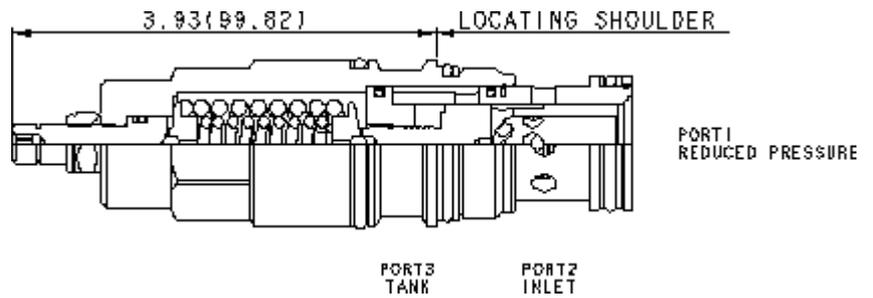
Les réducteurs de pression à action directe à 2 voies réduisent la pression primaire élevée de l'entrée (chambre 2) en une pression réduite constante dans la chambre 1. Ces valves sont amorties pour un fonctionnement stable autorisant un différentiel de pression élevé.
