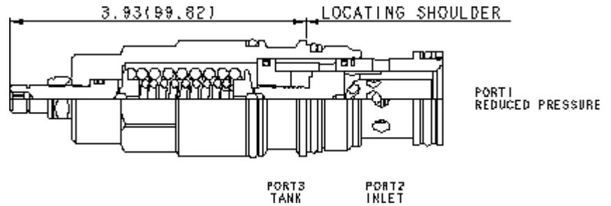
Direkt gesteuerte 2-Wege-Druckregelventile reduzieren einen hohen Primärdruck an Anschluss 2 auf einen niedrigeren, geregelten Druck an Anschluss 1. Die konstruktive Bedämpfung dieses Ventils führt zu stabiler Funktion auch bei hohen Differenzdrücken.
