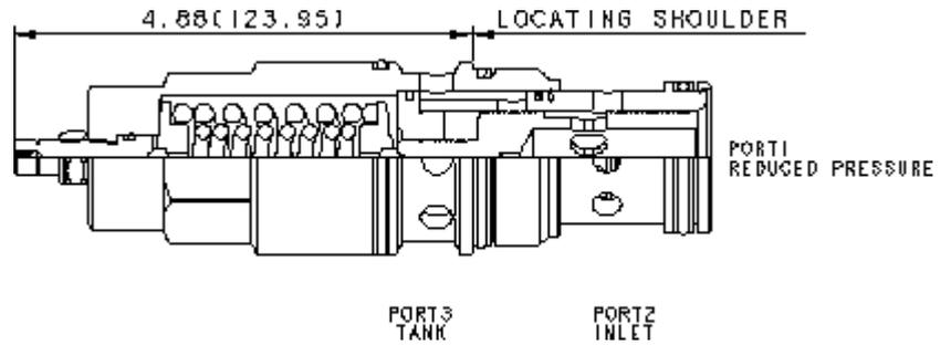
Les réducteurs de pression à action directe à 3 voies réduisent la pression primaire élevée de l'entrée (chambre 2) en une pression réduite constante dans la chambre 1 et fonctionnent en limiteur de pression capable du plein débit de la chambre 1 vers le réservoir (chambre 3). Ces valves sont amorties pour un fonctionnement stable autorisant un différentiel de pression élevé.
