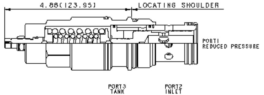
Les réducteurs de pression à action directe à 2 voies réduisent la pression primaire élevée de l'entrée (chambre 2) en une pression réduite constante dans la chambre 1. Ces valves sont amorties pour un fonctionnement stable autorisant un différentiel de pression élevé.
