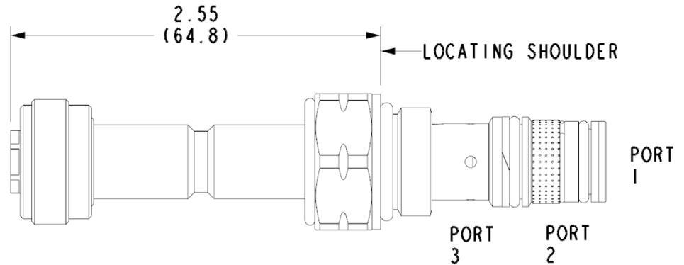
该电比例直动式减压溢流阀，将进口（2口）高压减压为一恒定出口（1口）压力，并在1口和3口之间带溢流功能。该阀初始为关闭状态。线圈通电时，将2口和1口连通。增加线圈电流将会成比例增加1口的减压压力。若1口压力超过了线圈电流决定的设定压力，1口将会往3口溢流。该阀在减压模式和溢流模式之间为闭式过渡位，因此具有较低泄漏。
