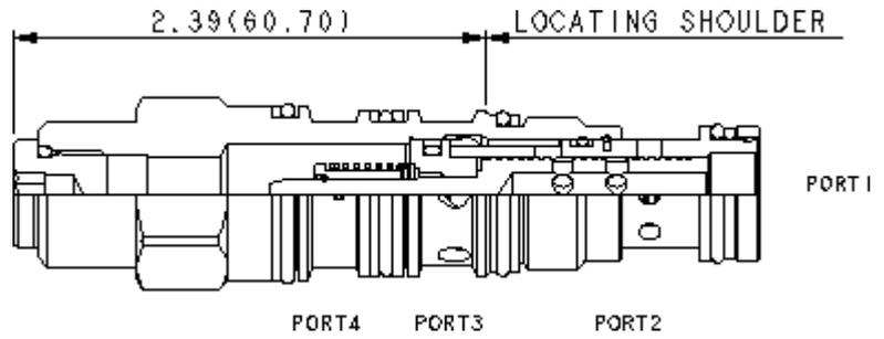
Direkt gesteuerte 3-Wege-Druckregelventile dienen als Schnittstelle zwischen Vorsteuerdrücken bei kleinen Volumenströmen am Anschluss 4 und Anwendungen mit höheren Durchflussanforderungen. Das Ventil reduziert einen hohen Primärdruck am Einlass (Anschluss 2) auf einen niedrigeren, geregelten Druck am Anschluss 1 mit einer Druckbegrenzungsfunktion vom Anschluss 1 zum Tank (Anschluss 3). Die konstruktive Bedämpfung dieses Ventils führt zu stabiler Funktion auch bei hohen Differenzdrücken.
