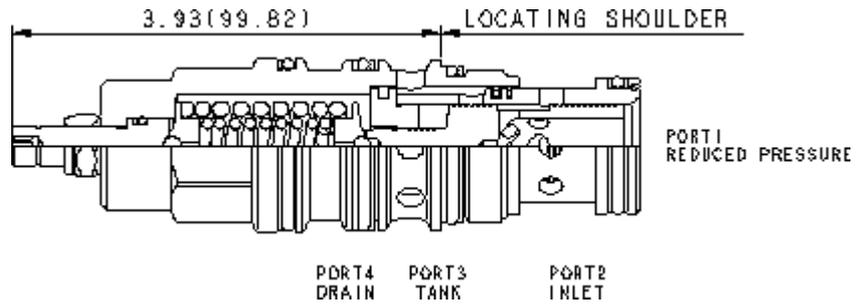
Direkt gesteuerte 3-Wege-Druckregelventile reduzieren einen hohen Primärdruck an Anschluss 2 auf einen niedrigeren, geregelten Druck an Anschluss 1. Die Druckbegrenzungsfunktion bewirkt, dass bei Überdruck an Anschluss 1 Öl über Anschluss 3 zum Tank abfließt. Eine Leckölabfuhr über Anschluss 4 macht das Ventil unempfindlich gegenüber Druck an Anschluss 3. Die konstruktive Bedämpfung dieses Ventils führt zu stabiler Funktion auch bei hohen Differenzdrücken.
