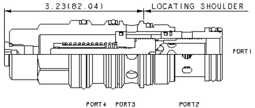
Direkt gesteuerte 3-Wege-Druckregelventile dienen als Schnittstelle zwischen Vorsteuerdrücken bei kleinen Volumenströmen am Anschluss 4 und Anwendungen mit höheren Durchflussanforderungen. Das Ventil reduziert einen hohen Primärdruck am Einlass (Anschluss 2) auf einen niedrigeren, geregelten Druck am Anschluss 1 mit einer Druckbegrenzungsfunktion vom Anschluss 1 zum Tank (Anschluss 3). Die konstruktive Bedämpfung dieses Ventils führt zu stabiler Funktion auch bei hohen Differenzdrücken.
