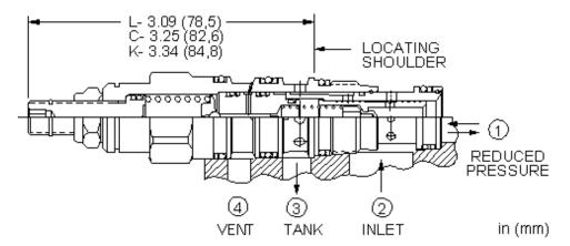
Les réducteurs de pression pilotés à 3 voies avec drain indépendant réduisent la pression primaire élevée de l'entrée (chambre 2) en une pression réduite constante dans la chambre 1, et fonctionnent en limiteur de pression capable du plein débit de la chambre 1 vers le réservoir (chambre 3). L'orifice de drainage peut être utilisé pour contrôler la valve à distance depuis une valve pilote ou une 2/2.
