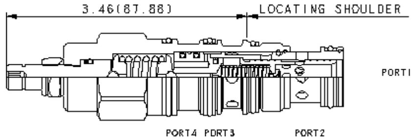
Les réducteurs de pression pilotés à 3 voies avec drain indépendant réduisent la pression primaire élevée de l'entrée (chambre 2) en une pression réduite constante dans la chambre 1, et fonctionnent en limiteur de pression capable du plein débit de la chambre 1 vers le réservoir (chambre 3). L'orifice de drainage peut être utilisé pour contrôler la valve à distance depuis une valve pilote ou une 2/2.
