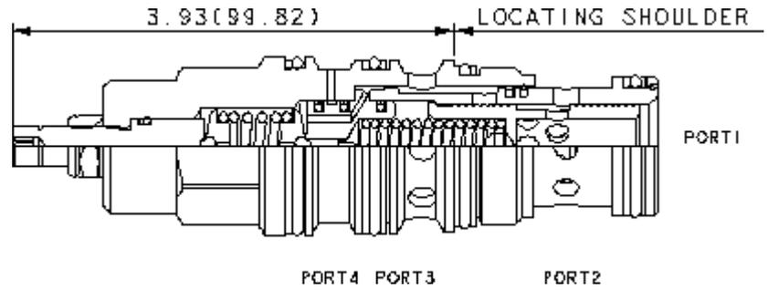
Les réducteurs de pression pilotés à 3 voies avec drain indépendant réduisent la pression primaire élevée de l'entrée (chambre 2) en une pression réduite constante dans la chambre 1, et fonctionnent en limiteur de pression capable du plein débit de la chambre 1 vers le réservoir (chambre 3). L'orifice de drainage peut être utilisé pour contrôler la valve à distance depuis une valve pilote ou une 2/2.
