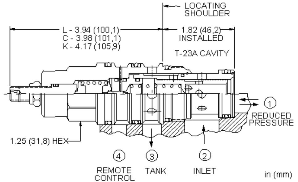
Entlastbare, vorgesteuerte 3-Wege-Druckregelventile reduzieren einen hohen Primärdruck an Anschluss 2 auf einen niedrigeren, geregelten Druck an Anschluss 1. Bei Überdruck an Anschluss 1 fließt Öl über Anschluss 3 zum Tank ab. Der Entlastungsanschluss 4 kann auch zur Fernsteuerung verwendet werden.
